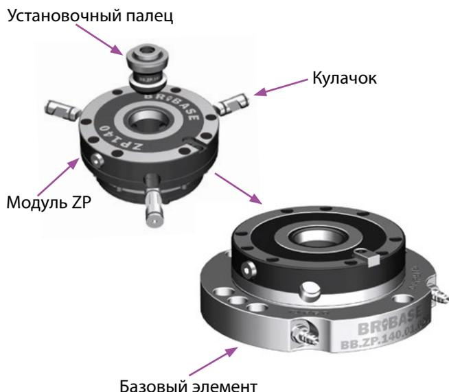
Устройства базирования состоят из модулей ZP и базового элемента. Модули ZP установлены в базовые элементы, которые обеспечивают подвод сжатого воздуха и закрепление системы на станке. Геометрическая форма и размеры базового элемента для модулей ZP зависят от типа оборудования, технологических задач и размеров приспособлений или деталей.
